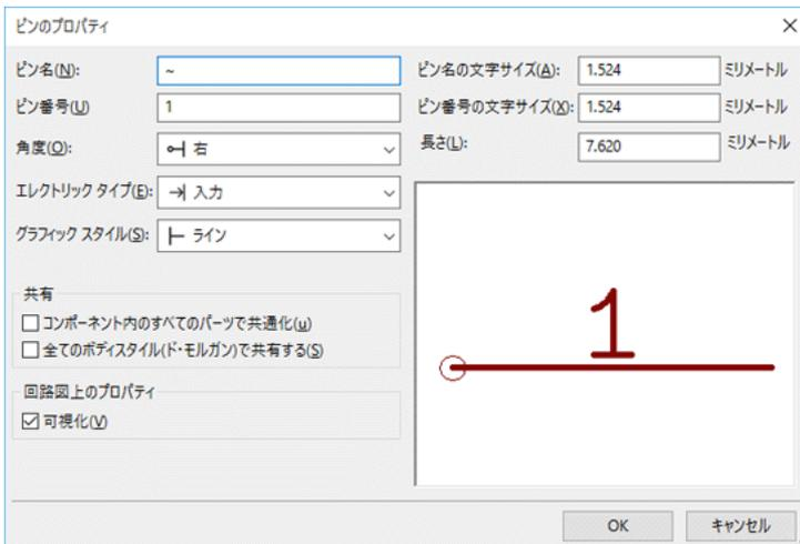
ピンプロパティダイアログでピンの全ての特性を編集することができます。このダイアログは、ピンを作成したり、あるいは既存のピンをダブルクリックすると、自動的にポップアップします。このメニューで以下の定義または変更が可能です。:
